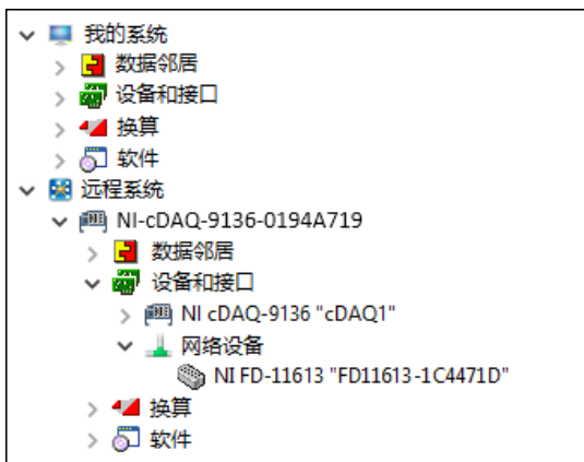
图 18. 将 FieldDAQ 设备添加到 MAX 中的 Real-Time 控制器
