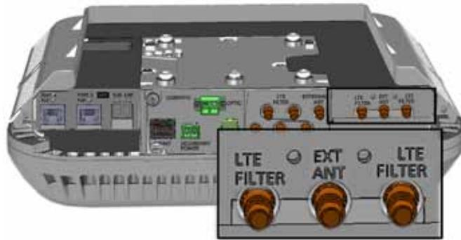
Figure 5-66. RxU module Interfaces
