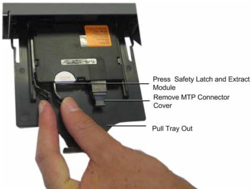
Figure 5-47. Extracting Edge Module
