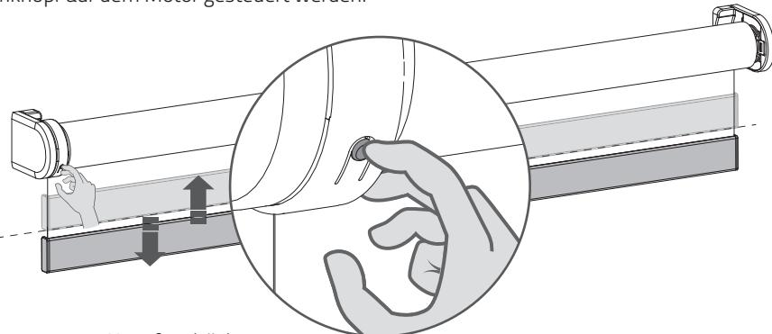
**19.1** Halten Sie den **Programm**-Knopf gedrückt, um das Rollo manuell zu bedienen. Das Rollo wird sich bewegen, solange der Knopf gedrückt gehalten wird. (Max. 15 Sek.)
