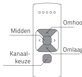
**Afstandsbediening:** Kies met behulp van de knop **kanaal** het kanaal waaraan het rolgordijn is gekoppeld. Druk op de knop **omhoog** of **omlaag** om het rolgordijn te bedienen. Druk op de knop **midden** om het rolgordijn te stoppen.
