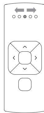
**20.3** Nadat er een rolgordijn is gevonden, knippert het ledlampje van het kanaal en begint het rolgordijn te draaien om aan te geven dat de programmeermodus is geactiveerd. Het rolgordijn kan nu worden gekoppeld/ontkoppeld van de afstandsbediening en/of worden geprogrammeerd.
