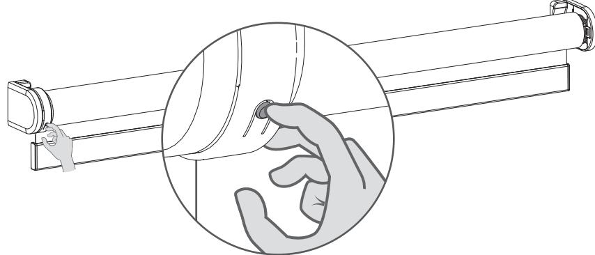
**6.1** Drücken Sie kurz den **Programm**-Knopf auf dem Motor. Das Rollo beginnt, sich schrittweise zu bewegen, um anzudeuten, dass der Programmmodus aktiviert wurde. (Das Rollo bewegt sich schrittweise, bis der Programmmodus deaktiviert wird.)
