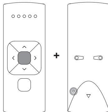
**20.2** El mando empezará a buscar persianas (modo de búsqueda). Esto se indica mediante el parpadeo de las luces LED de izquierda a derecha.
