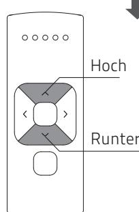
**7.1** Drücken Sie kurz den **Runter**-Knopf, um zu prüfen, ob das Rollo sich in der richtigen Richtung entrollt. Wenn das Rollo sich nach oben bewegt, muss die Rotationsrichtung verändert werden.
