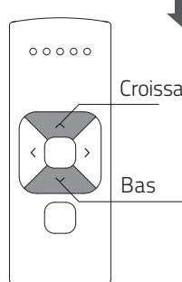
**7.1** Appuyez brièvement sur la **touche** down pour vérifier si le store se déroule correctement. Si le store se soulève, le sens de rotation doit être modifié.
