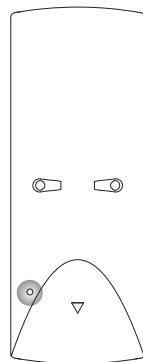
**20.2** Die Fernbedienung beginnt, nach Rollos zu suchen (Suchmodus). Dies wird angezeigt, indem die LEDs von links nach rechts blinken.
