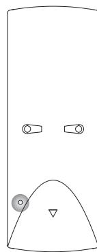
**20.2** De afstandsbediening begint te zoeken naar rolgordijnen (zoekmodus). Deze modus wordt aangegeven doordat de ledlampjes van links naar rechts knipperen.
