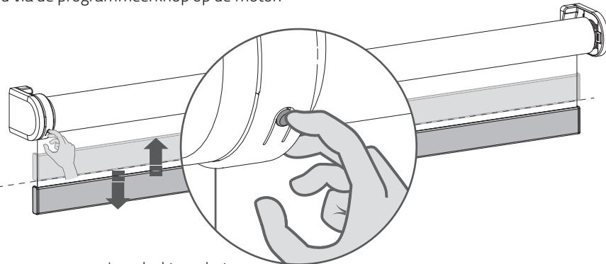
**19.1** Houd de knop **programmeren** ingedrukt om het rolgordijn handmatig te bedienen. Het rolgordijn zal bewegen zo lang de knop wordt ingedrukt (max. 15 sec.).
