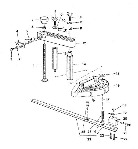
FIGURE 4 - MITER GAUGE/HOLD DOWN ASSEMBLY 62776
