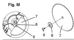
Installing Blade (Fig. K, L, M)
