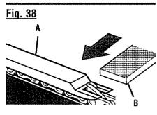
A-Depth gauge jointer (igualador de calibres de profundidad) B-Flat file (lima plana)
