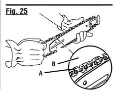
A - Chain drive links (eslabones de impulsión de la cadena) B - Bar groove (ranura de la barra)
