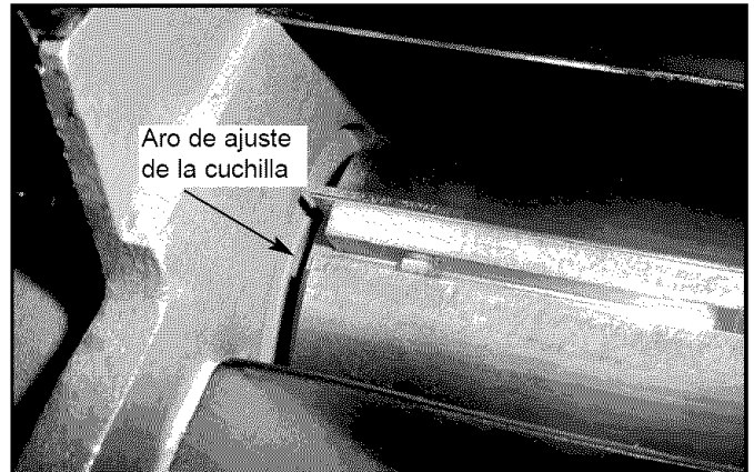
Figura 23 – Utilice Aros de Ajuste para Colocar las Cuchillas
