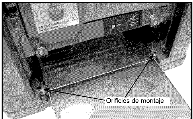
Figura 7 – Orificios de Montaje de la Cepilladora (Frente)
