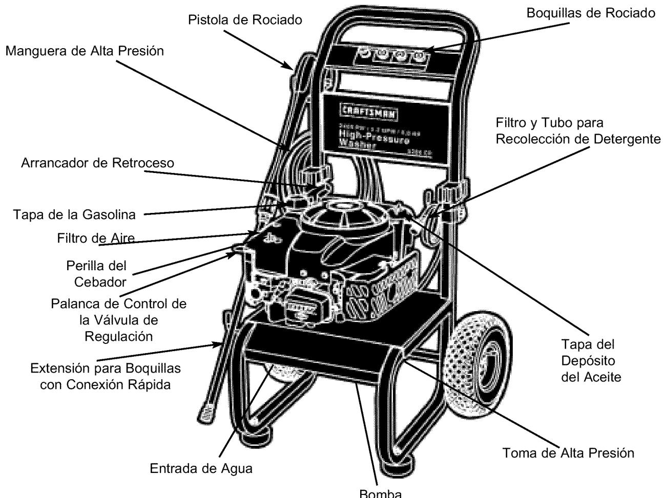
**Filtro de Aire** – El elemento de filtro tipo seco limita la cantidad de suciedad y polvo que se introduce en el motor.
