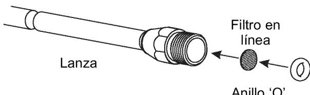
2. Si el colador está dañado, encontrará un colador para el filtro en línea y un anillo 'o' de repuesto en el juego de anillos 'o'. Si no está dañado, vuelva a usarlo.
