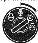
Motor en posición "ON" (Operación Normal)
