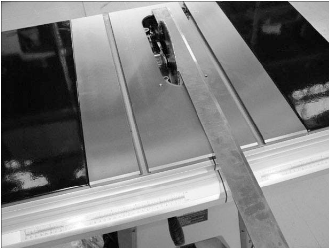
Figura 25 - Use una Regla de Borde Recto para Alinear la Junta del Riel a la Hoja
