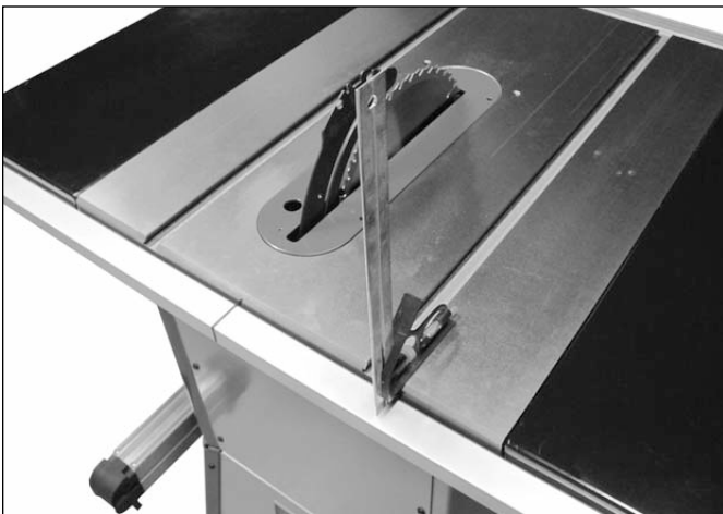
Figura 26 - Revise el paralelismo de los rieles a la mesa con una escuadra de combinación. Revise varias secciones del riel.
