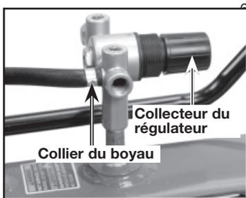
Appliquez un produit d'étanchéité pour tuyaux au collecteur de régulateur neuf et montez-le. Serrez le collecteur avec une clé.
