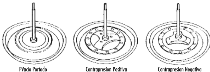
FIGURA 7: DIAFRAGMAS DE RECIRCULACIÓN DE LOS GASES DE ESCAPE FABRICADOS POR GM
