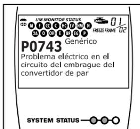
4. **Diodos electroluminiscentes (LED) amarillo y rojo intermitente** - Indican que se ha establecido un código "permanente" y que uno o más de los monitores del vehículo ha fallado en su prueba de diagnóstico. Un código DTC "permanente" se puede borrar únicamente a través de la computadora del vehículo después de completar con éxito la prueba de diagnóstico del monitor que causó el establecimiento del fallo.
