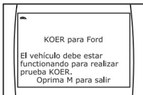
2. En la pantalla de la herramienta de diagnóstico aparece un mensaje "instructivo". Lleve a cabo los procedimientos de prueba según corresponda.
