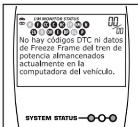
A partir del procedimiento de recuperación de códigos, determine el estado de cada monitor (un icono de monitor que se encienda de manera continua indica el estado "Se ha ejecutado" del monitor, un icono de monitor intermitente indica el estado "No se ha ejecutado"). Lleve esta información a un profesional de pruebas de emisiones para que determine (con base en los resultados de sus pruebas) si su vehículo está listo para una prueba de emisiones (verificación de contaminación ambiental).
