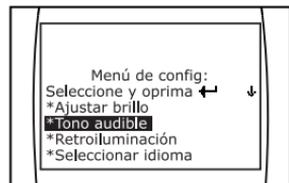
2. Pulse el botón **DOWN**
