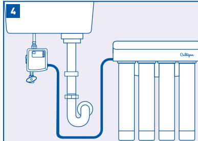
Conecte la entrada del sistema de filtración al puerto titulado "RO/Filter>" de la caja de control. Moje el extremo del tubo de plástico con agua y empújelo en el adaptador de conexión rápida aproximadamente 5/8" hasta que pare.
