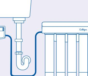
Conecte la entrada del sistema de filtración al puerto titulado "RO/Filter>" de la caja de control. Moje el extremo del tubo de plástico con agua y empújelo en el adaptador de conexión rápida aproximadamente 5/8" hasta que pare.
