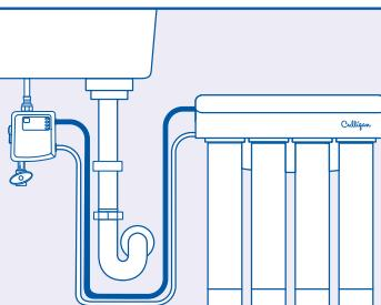
Conecte la salida del sistema de filtración al puerto titulado "RO/Filter<" de la caja de control. Moje el extremo del tubo de plástico con agua y empújelo en el adaptador de conexión rápida aproximadamente 5/8" hasta que pare.
