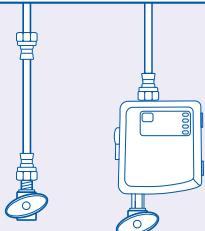
Aprieta la caja de control a la válvula de cierre de agua fría según la diagrama. Aprieta la parte inferior de la línea de agua fría a la parte superior de la caja de control.
