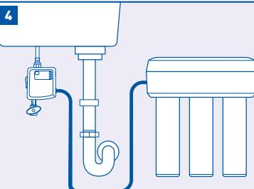
Conecte la entrada del sistema de filtración al puerto azul titulado "RO/Filter>" de la caja de control. Moje el extremo del tubo de plástico con agua y empújelo en el adaptador de conexión rápida aproximadamente 5/8" hasta que pare.
