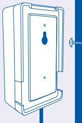
Use el tornillo provisto para colgar la caja de baterías a la pared interior del cabinete.
