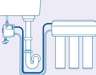
Conecte la salida del sistema de filtración al puerto blanco titulado "RO/Filter<" de la caja de control. Moje el extremo del tubo de plástico con agua y empújelo en el adaptador de conexión rápida aproximadamente 5/8" hasta que pare.
