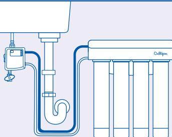
Conecte la salida del sistema de filtración al puerto titulado "RO/Filter<" de la caja de control. Moje el extremo del tubo de plástico con agua y empújelo en el adaptador de conexión rápida aproximadamente 5/8" hasta que pare.
