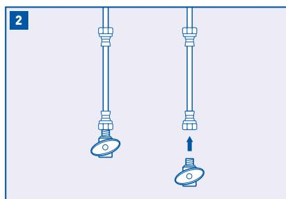
Desconecte la línea de agua fría de la válvula de cierre de agua fría.
