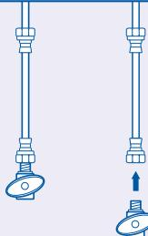
Desconecte la línea de agua fría de la válvula de cierre de agua fría.
