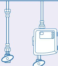
Aprieta la caja de control a la válvula de cierre de agua fría según el diagrama. Aprieta la parte inferior de la línea de agua fría a la parte superior de la caja de control.
