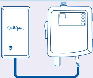
Instale cuatro baterías C (no incluidas) en la caja de pilas y enchufe al gato en la parte inferior de la caja de control.
