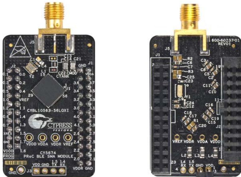
Figure A-8. CY5674 PRoC BLE SMA Module
