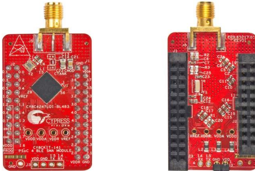
Figure A-4. CY8CKIT-141 PSoC 4 BLE SMA Module
