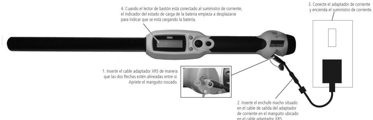
El lector de bastón puede ser usado mientras que se está cargando la batería.
