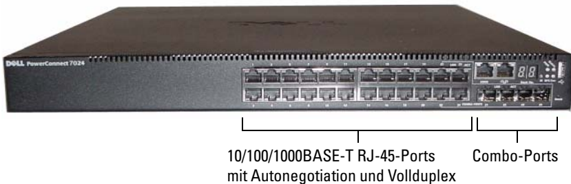
Abbildung 1-2. PowerConnect 7024P mit 24 10/100/1000BASE-T PoE Plus-Ports
