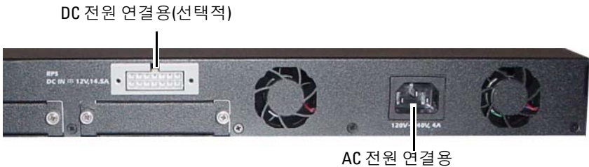
그림 1-15. 스위치에 AC 및 DC 전원 연결
