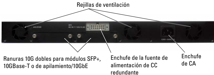
Ilustración 1-9. Panel posterior de PC7024P y PC7048P
