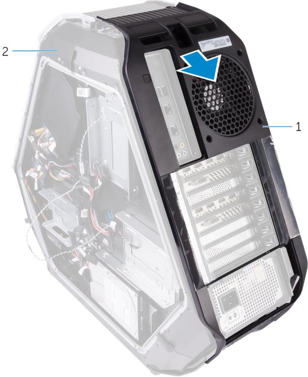
图 71: 卸下后挡板
