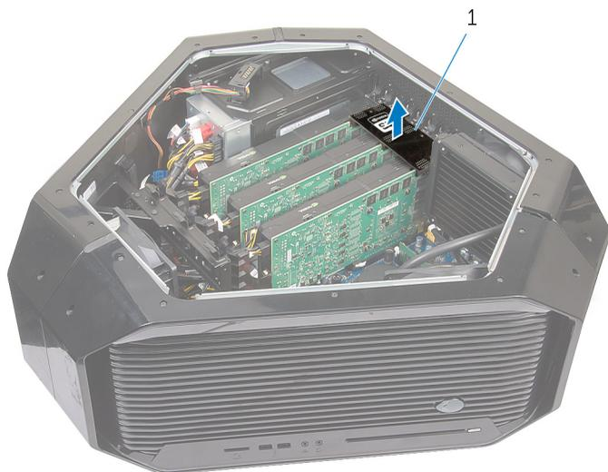
**图 27: 卸下图形卡桥接器**
