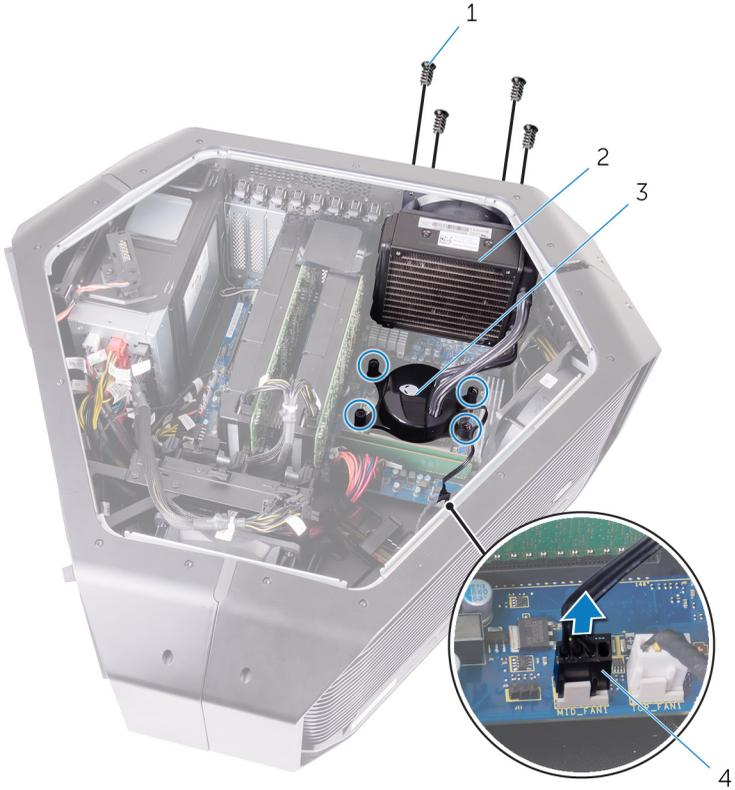
图 45: 卸下处理器液体冷却部件
