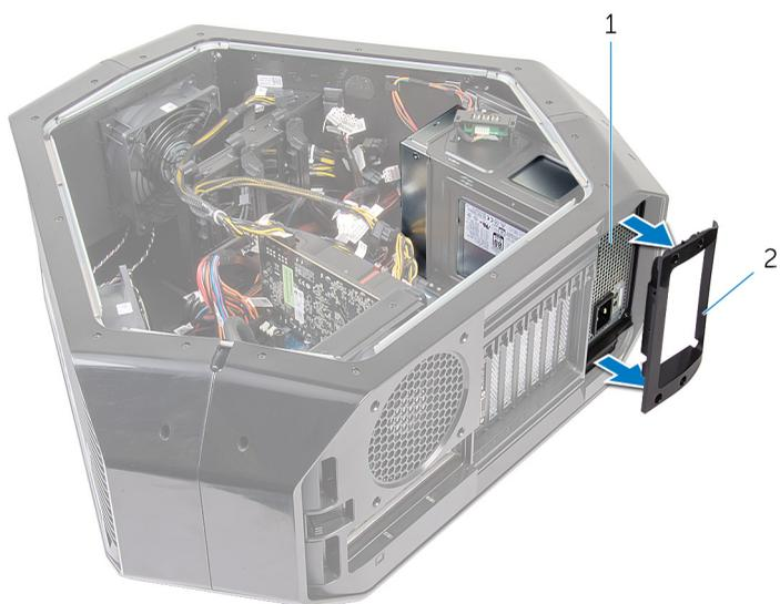
图 50: 卸下电源装置
