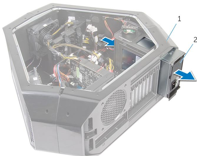
图 51: 卸下电源装置
