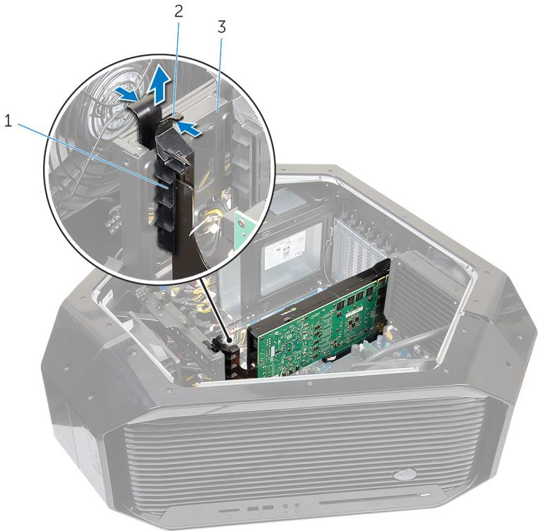
图 30: 卸下将全长图形卡
