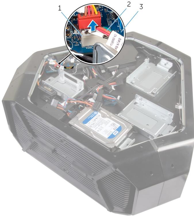
**图 17: 图：卸下左侧 AlienFX 连接器**
