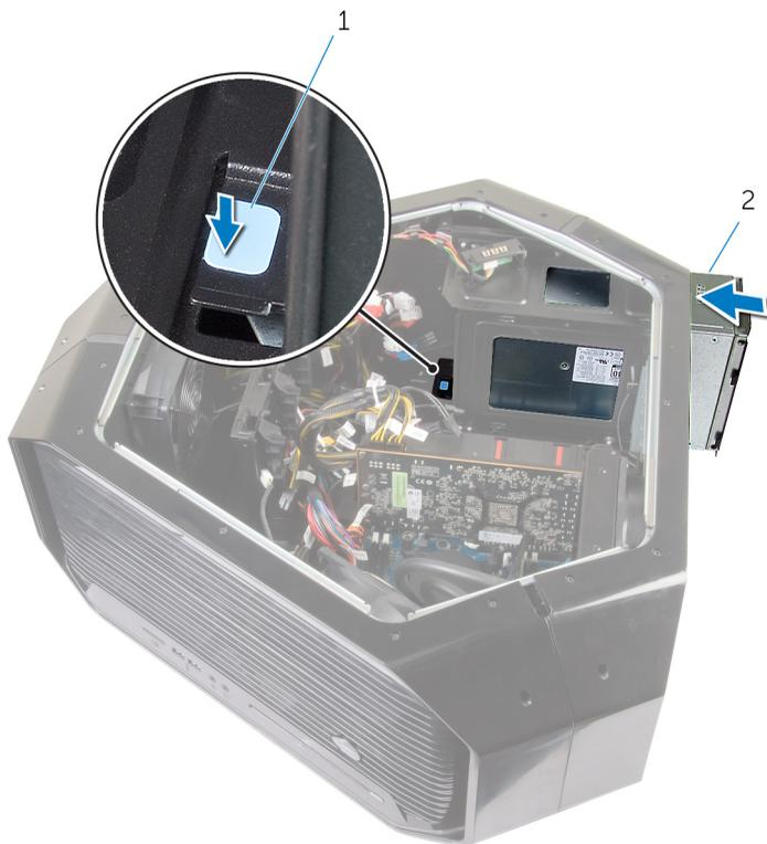
图 52: 装回电源装置
