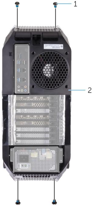
图 69: 卸下后挡板
