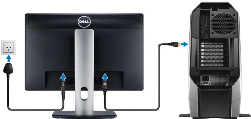
**ANMERKUNG:** Der DisplayPort auf der Rückseite des Computers verfügt über eine Abdeckung. Zum Anschluss des Bildschirms an die separate Grafikkarte des Computers.
