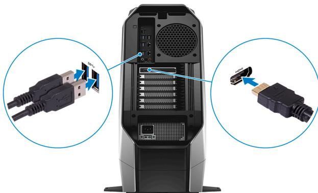
**ANMERKUNG:** Verbinden Sie das Headset mit dem HDMI-Anschluss an der diskreten Grafikkarte und den Bildschirm mit einem der verfügbaren Anschlüsse an der Karte.
