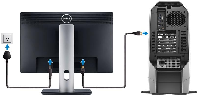
注: 您的计算机背面板上会包含 **DisplayPort**。将显示器连接到计算机的独立显卡。
