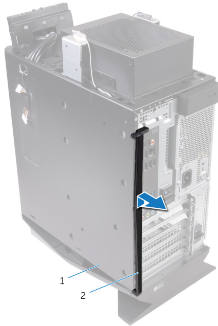
Figur 49. Ta av det bakre pyntedekselet
