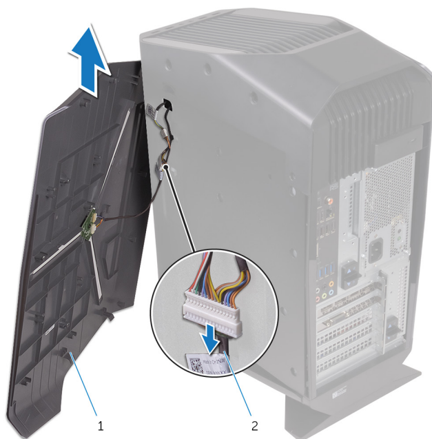
Рисунок 5. Снятие правой крышки
