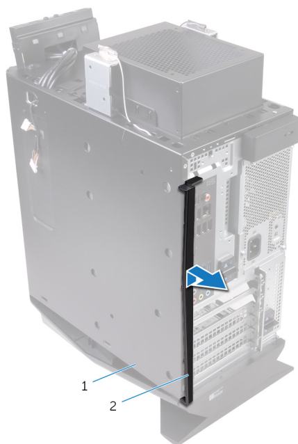
Рисунок 49. Снятие задней облицовочной крышки
