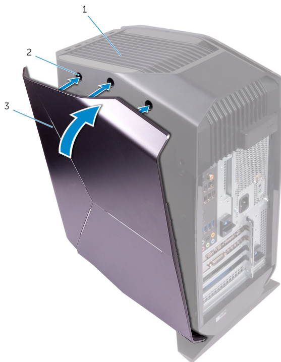
Рисунок 7. Установка правой крышки
