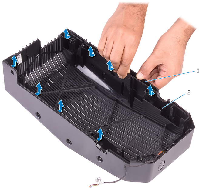
Рисунок 10. Снятие верхней крышки с верхней лицевой панели
