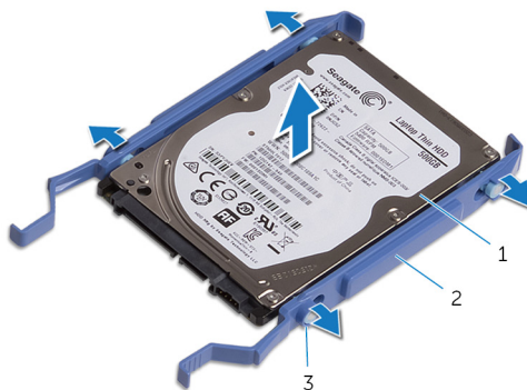
Рисунок 16. Извлечение жесткого диска из держателя
