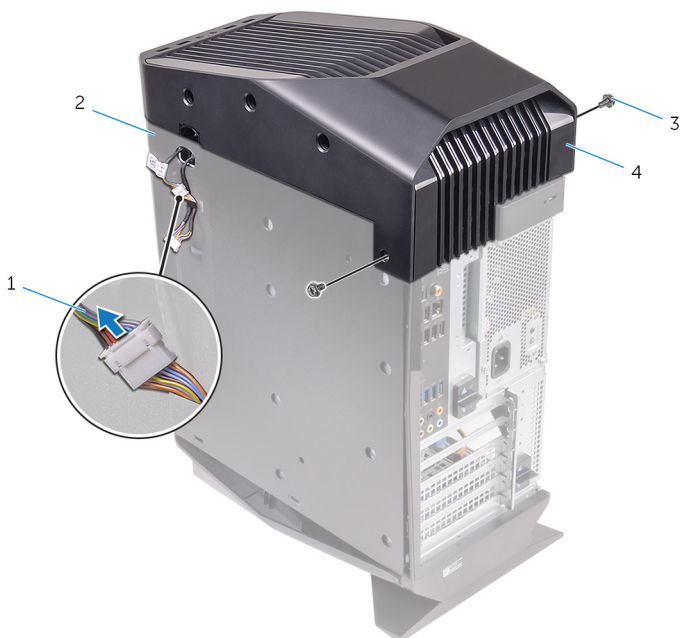
Рисунок 8. Снятие верхней крышки
