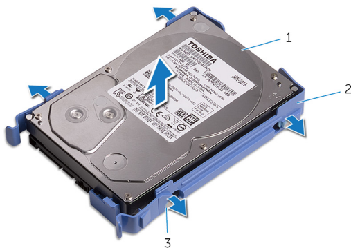
Рисунок 14. Извлечение жесткого диска из каркаса жесткого диска
