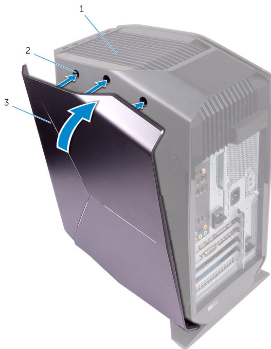
Figur 7. Sätta tillbaka den högra kåpan
