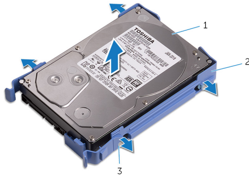
Figur 14. Ta bort hårddisken från hårddiskhållaren
