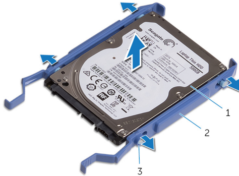
Figur 16. Ta bort hårddisken från hårddiskhållaren
