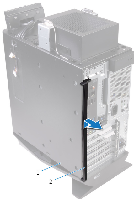
Figur 49. Ta bort det bakre trimhöljet
