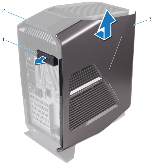
Figur 2. Ta bort den vänstra kåpan
