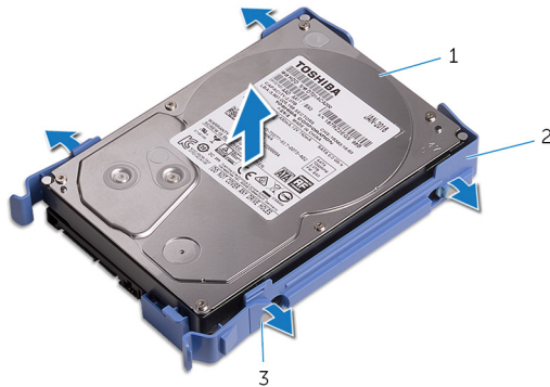
Figura 14. Rimozione del disco rigido dal relativo supporto
