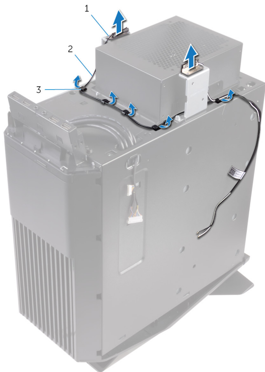
Figura 36. Rimuovere i cavi dell'antenna
