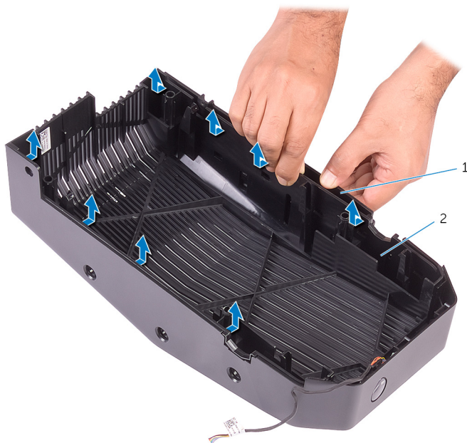
Figura 10. Rilasciare il coperchio superiore dalla cornice superiore.
