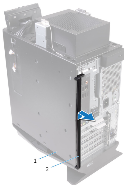
Figura 49. Rimuovere il pannello posteriore
