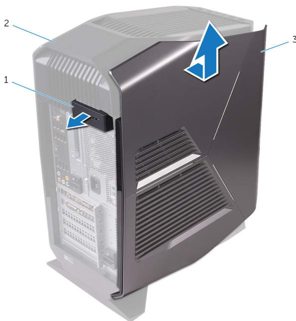
Figura 2. Rimozione del pannello laterale sinistro
