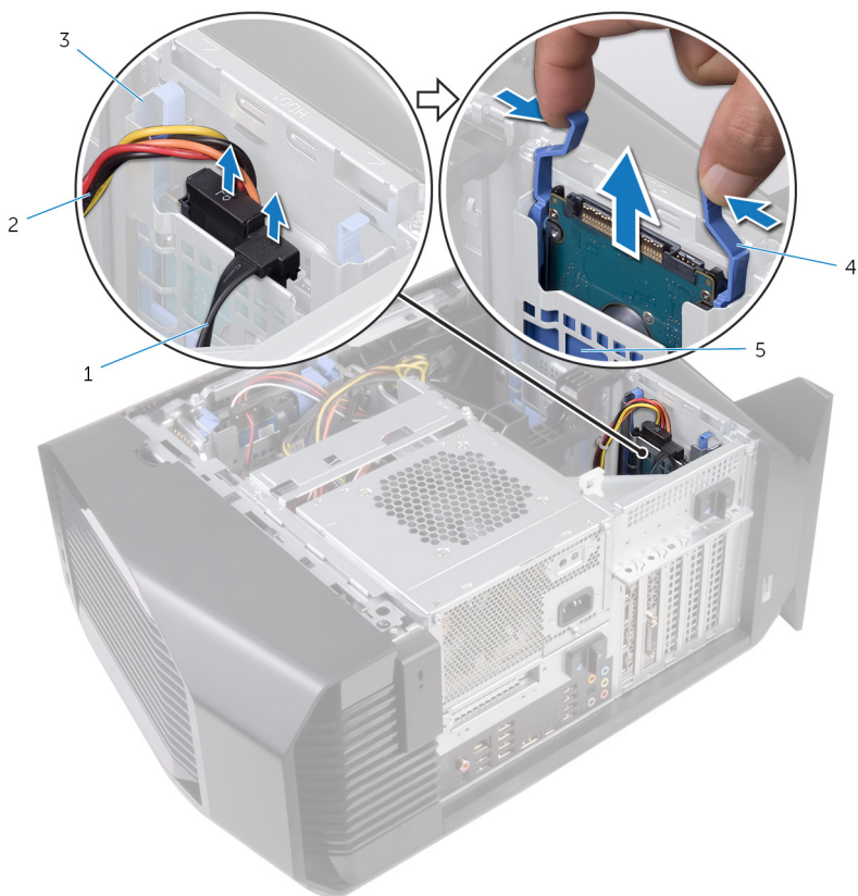
Figura 15. Rimozione del disco rigido
