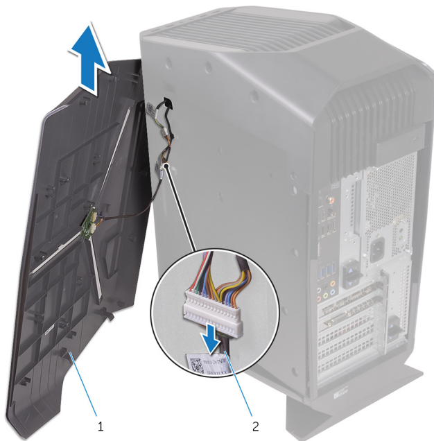
Figur 5. Fjernelse af højre sides dæksel
