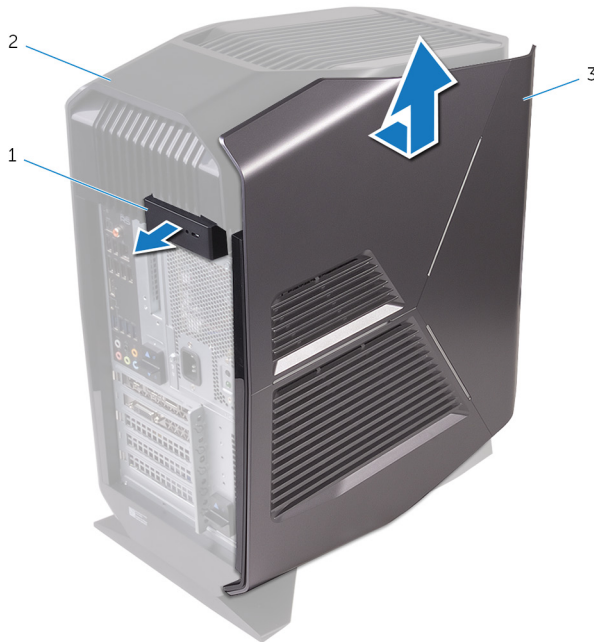
Skica 2. Odstranjevanje levega pokrova
