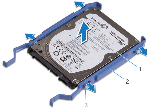
Skica 16. Odstranitev trdega diska iz nosilca trdega diska
