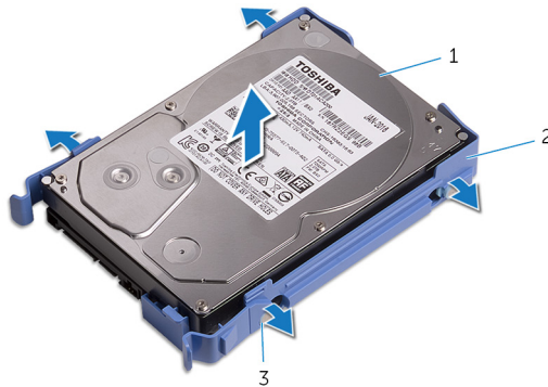
Abbildung 14. Festplattenlaufwerk aus der Festplattenlaufwerkhalterung entfernen
