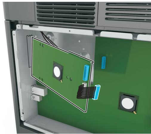
**Nota:** Coloque el ISP en ángulo sobre el soporte de plástico para que cualquier conector que sobresalga pase por la abertura del ISP en la carcasa de la placa del controlador.
