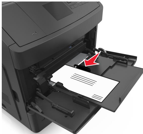
**Advertencia—Posibles daños:** No utilice nunca sobres con sellos, cierres, broches, ventanas, revestimientos oleosos o autoadhesivos. Este tipo de sobres pueden causar un grave deterioro en la impresora.
