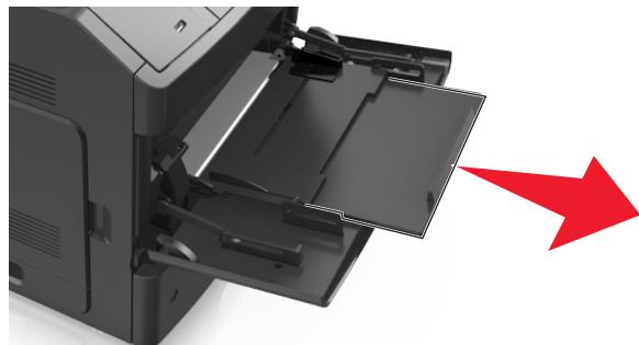
**Nota:** Mueva con cuidado la parte extensible para que el alimentador multiuso quede completamente extendido y abierto.
