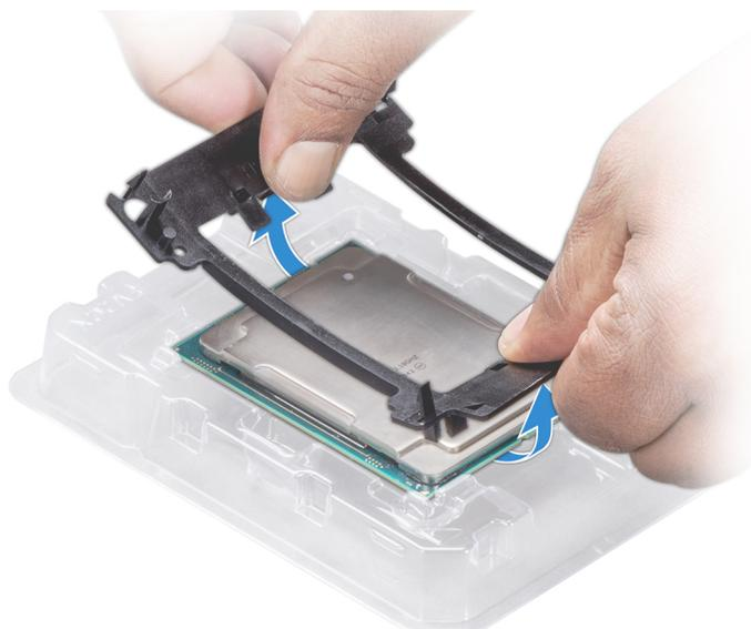
図 33. プロセッサブラケットの取り外し
