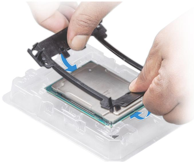
図 34. プロセッサブラケットの取り付け
