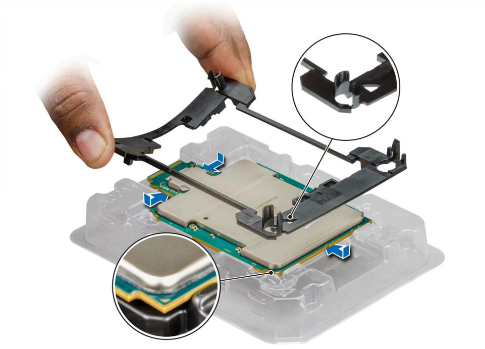
図 29. プロセッサブラケットの取り付け
