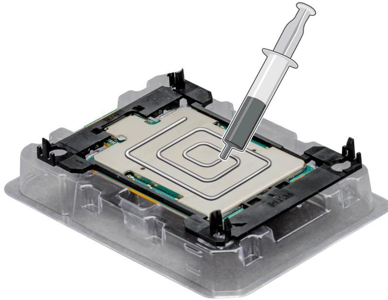
図 30. プロセッサの上部へのサーマルグリースの塗布
