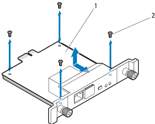
b החלק את מערכם ① PMC אל תוך ה- PDU ובבטח אותם באמצעות שני בורגי הכנף ②.
