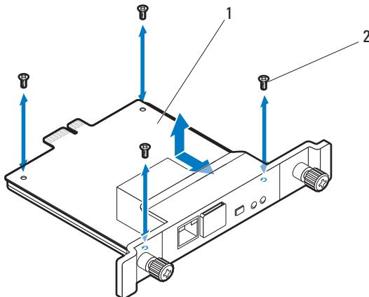
b Vložte takto smontovanou jednotku PMC 1 do jednotky rozvaděče a upevněte ji dvěma křídlatými šrouby 2.
