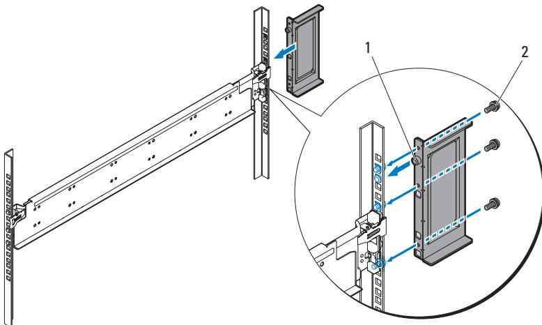
**4** Fije el riel derecho y el soporte de detención al bastidor.
