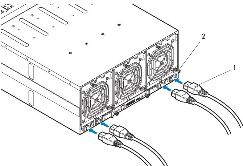
2. לחבר את הקצה השני של כבלי החשמל לשקע חשמלי מוארך או למקור אחר נפרד, כגון מערכת אל-פסק או יחידת חלוקת המתח (PDU).
