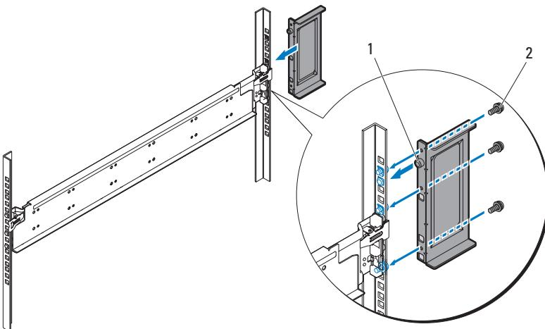
**4** Zamocuj prawą szynę i wspornik blokujący do szafy typu rack.
