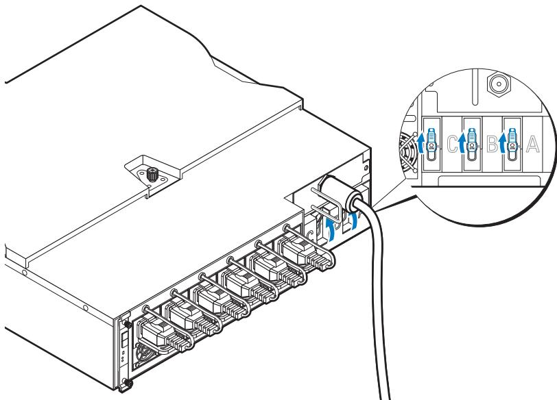
**4** כדי לאפשר ניטור התקן ה-PDU באמצעות הרשת, הפעיל את לוח ה-PMC באמצעות לחיצה על לחצן ההפעלה, הממוקם בלוח ה-PMC. כאשר ה-PDU מקבל חשמל, מוחון הפעלה/השלט שהזיהית ה-PMC דולק בצד ימין.
