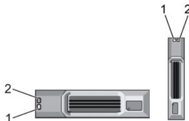
Abbildung 5. SCv300- und SCv320-Erweiterungsgehäuse – Laufwerksanzeigen
