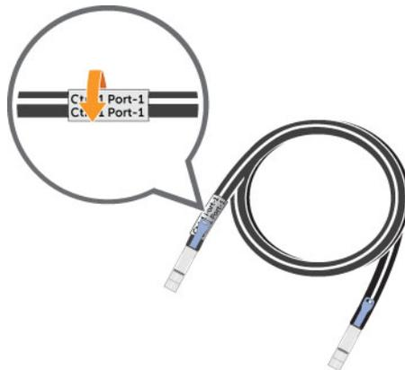
図 41. ラベルをケーブルに巻き付ける
