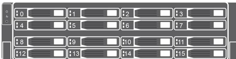
図 9. SCv3000 ストレージシステムドライブの番号付け
