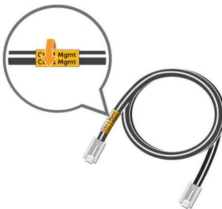
図 44. ラベルをケーブルに巻き付ける
