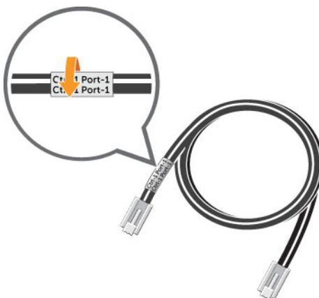
図 38. ケーブルへのラベルの巻き付け
