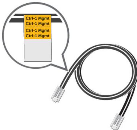
図 43. ケーブルへのラベルの取り付け
