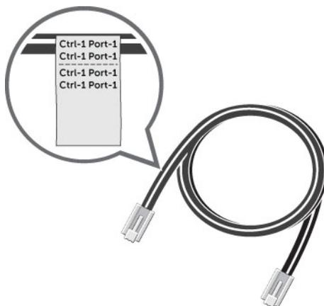
図 37. ケーブルへのラベルの取り付け
