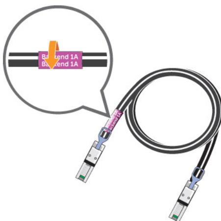
図 50. ラベルをケーブルに巻き付ける
