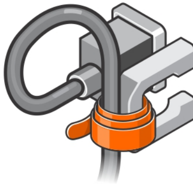
図 12. 電源ケーブルからのマジックテープストラップの取り外し
