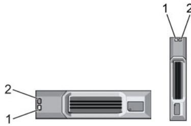
Figura 8. Indicadores de las unidades del Gabinete de expansión SCv300 y SCv320
