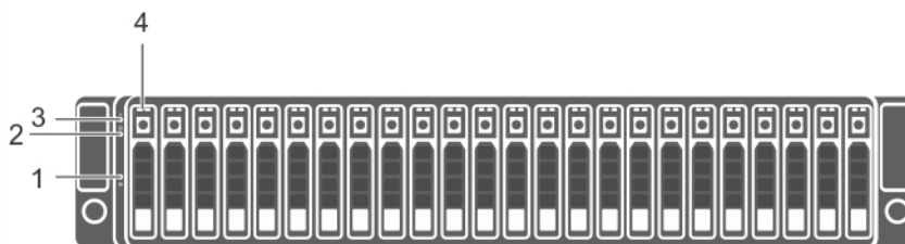
Figura 14. Funciones e indicadores del panel frontal del SCv320
