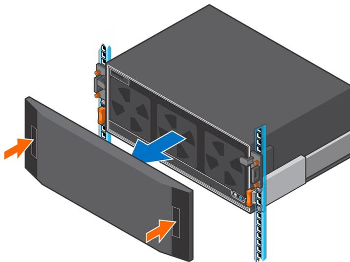
Abbildung 30. Entfernen der Blende
