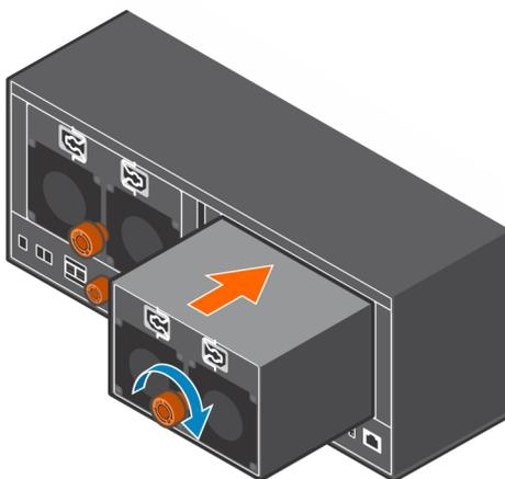
**Abbildung 48. Installieren eines Netzteils (PSU)**
