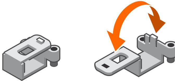
**Abbildung 10. Öffnen der Kabelkettenverriegelungen**
