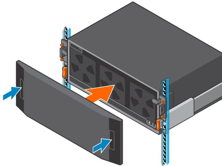
**Abbildung 29. Installieren der Blende**
