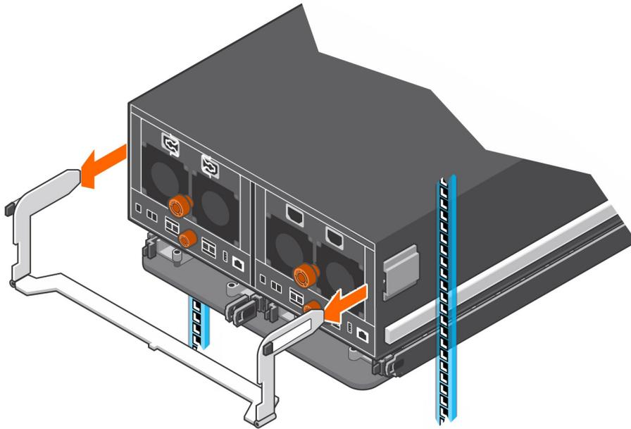
**Abbildung 52. Entfernen der Gehäusehalterung vom Gehäuse**
