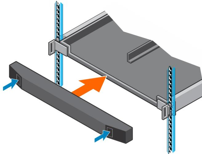
**Abbildung 65. Frontverkleidung anbringen**
