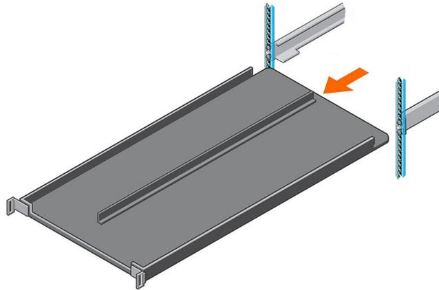
**Abbildung 55. Entfernen des Fach aus den Schienen**
