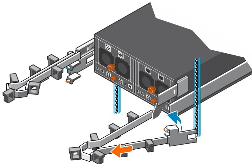
**Abbildung 22. Ausrichten des Verlängerungsarms mit Schienenhalterung**
