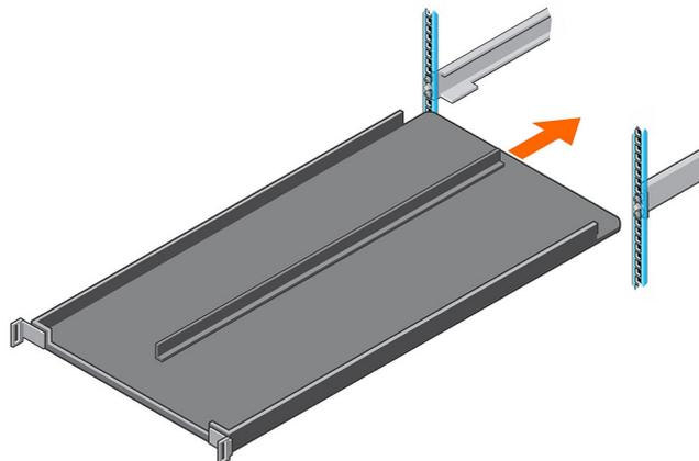
**Abbildung 9. Ausrichten des Kabelverwaltungs-fachs**
