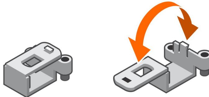
**Abbildung 53. Öffnen der Kabelkettenverriegelungen**
