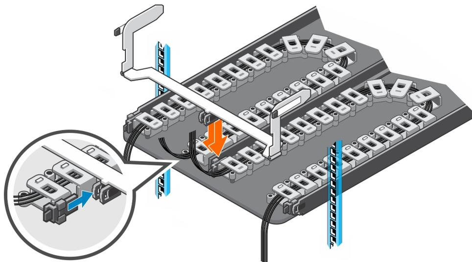
Abbildung 14. Festklammern der Kabelketten an Gehäusehalterung
