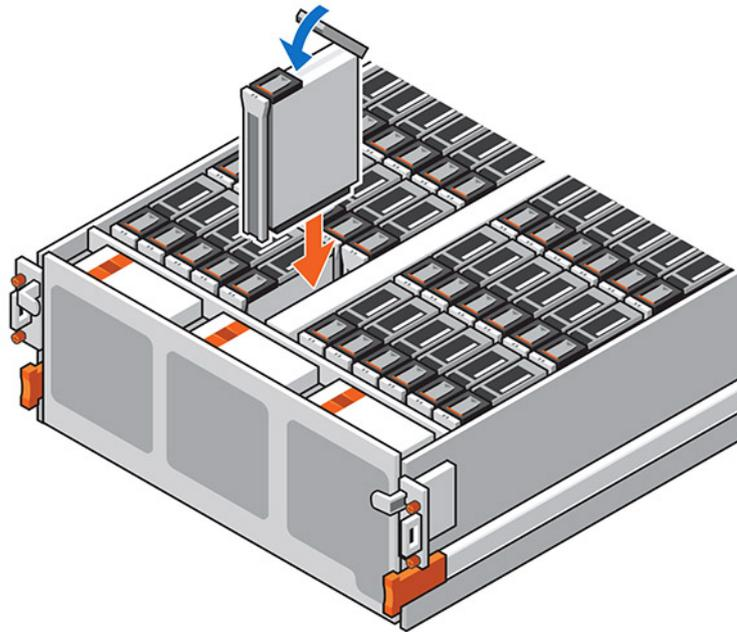
Abbildung 36. Installation eines Festplattenlaufwerks
