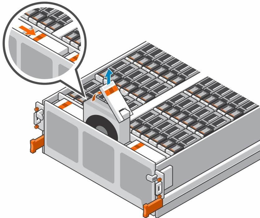
Abbildung 39. Entfernen eines Kühlungslüfter-Moduls
