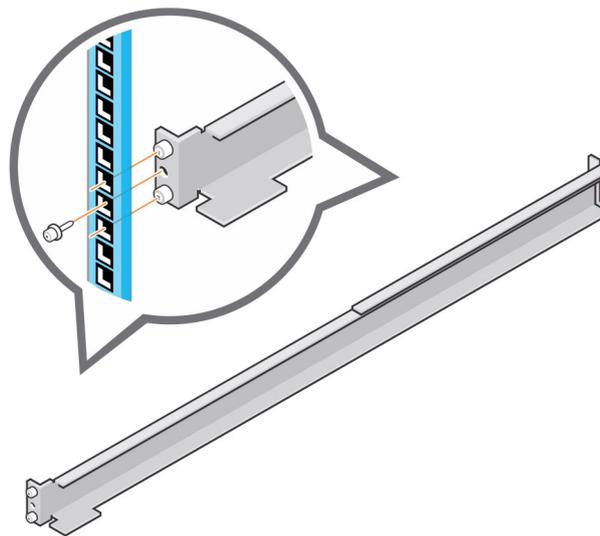
**Abbildung 56. Entfernen der Schienen aus dem Rack**
