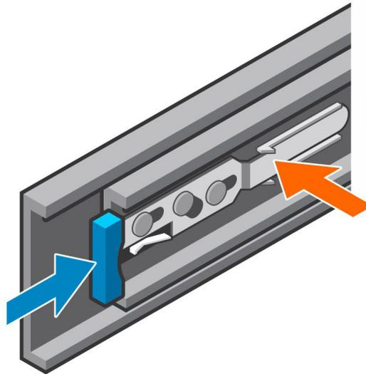
**Abbildung 57. Drücken der blauen Lasche an den Erweiterungsgehäuse-Schienen**
