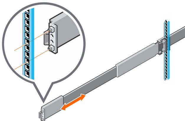
**Abbildung 79. Bringen Sie die Schiene an der Vorderseite des Racks an.**
