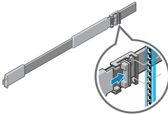
**Abbildung 17. Bringen Sie die Schiene an der Rückseite des Racks an.**
