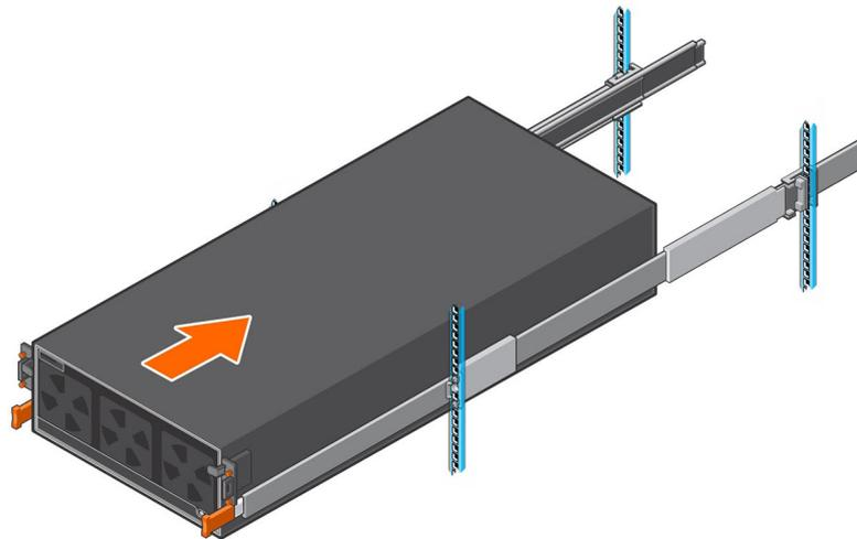
**Abbildung 20. Montage des Erweiterungsgehäuse im Rack**
