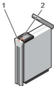
Abbildung 3. SCv360 – Laufwerksanzeigen
