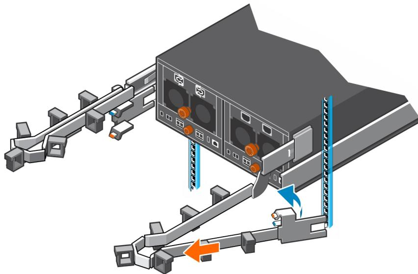
**Abbildung 72. Ausrichten des Verlängerungsarms mit Schienenhalterung**
