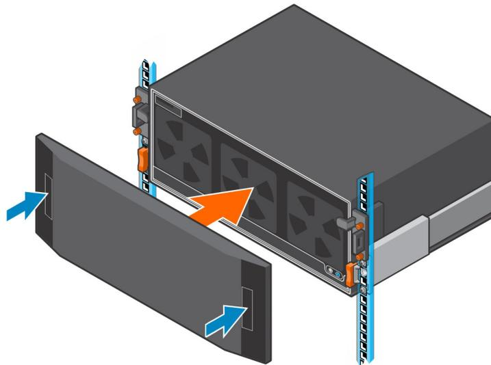
**Abbildung 31. Installieren der Blende**
