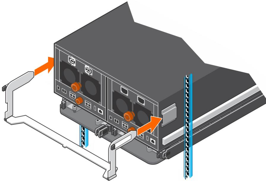
**Abbildung 63. Installieren der Gehäusehalterung am Gehäuse**
