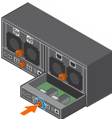
**Abbildung 44. Installieren eines EMMs**
