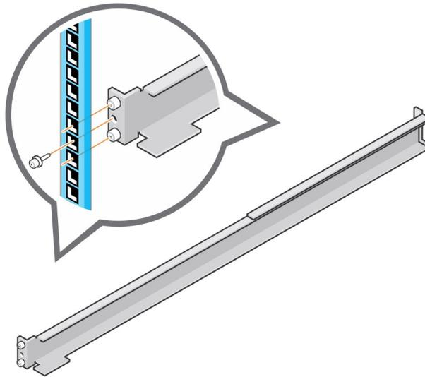
**Abbildung 8. Befestigen der Schienen am Rack**
