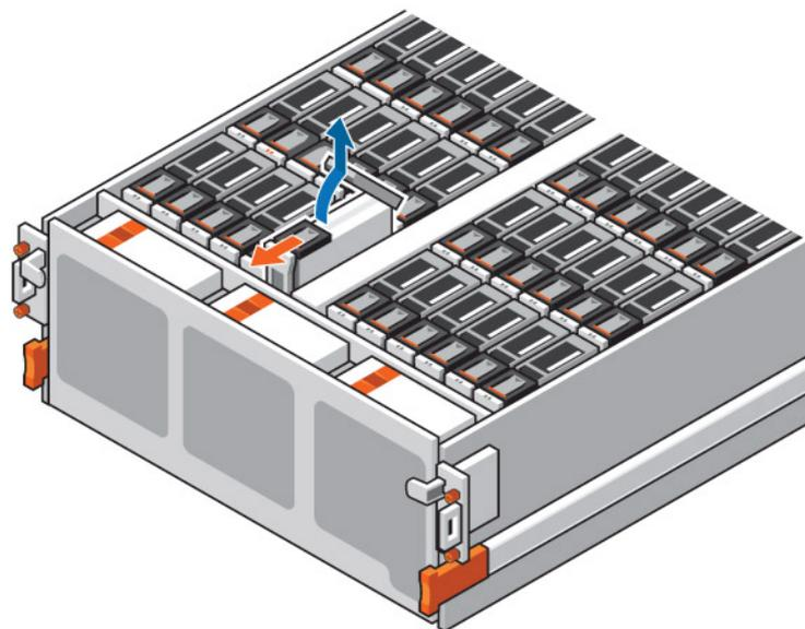
**Abbildung 34. Lösen eines Festplattenlaufwerks**
