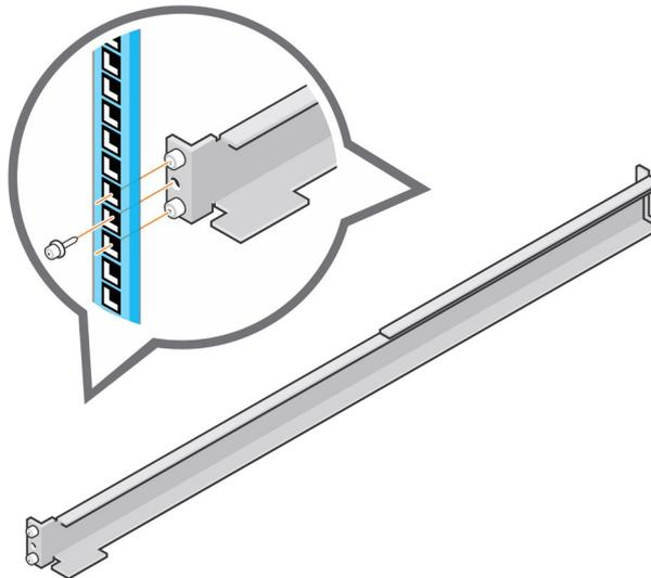
**Abbildung 58. Befestigen der Schienen am Rack**
