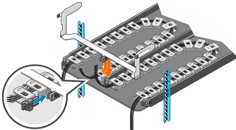
**Abbildung 50. Trennen der Kabelketten von der Gehäusehalterung**
