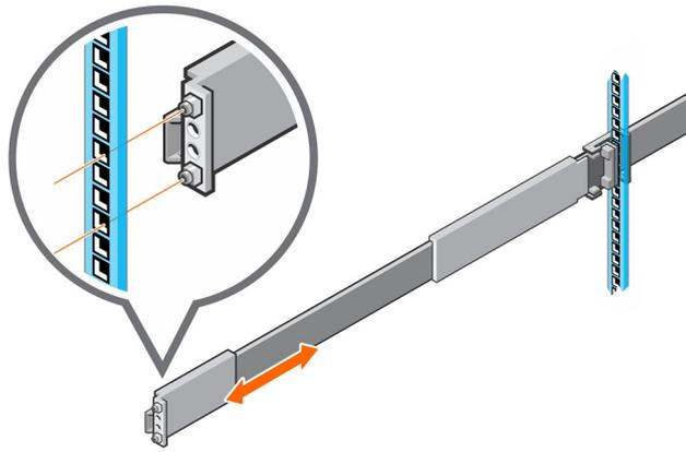
**Abbildung 18. Bringen Sie die Schiene an der Vorderseite des Racks an.**
