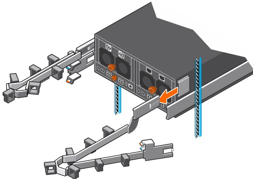
**Abbildung 70. Lösen des Kabelführungsarm aus der Halterung**
