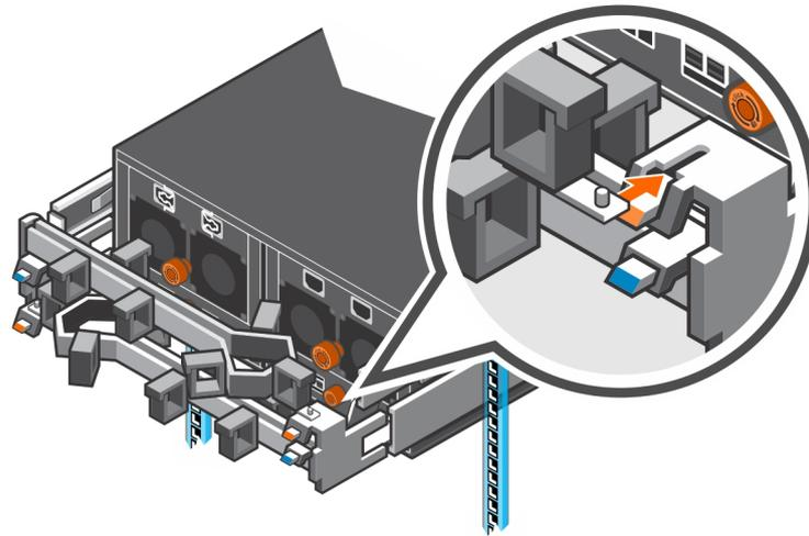
**Abbildung 27. Sicherstellen, dass Kabelführungsarme befestigt sind**
