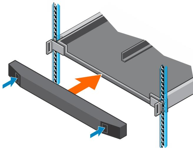
Abbildung 15. Frontverkleidung anbringen
