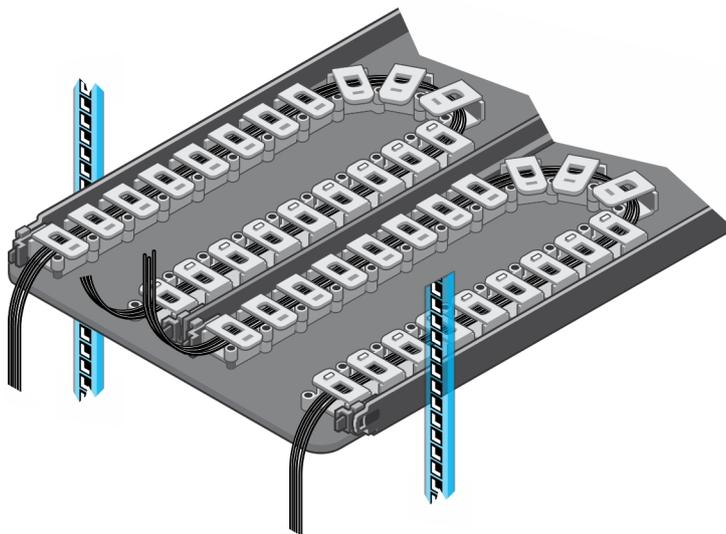
**Abbildung 11. Positionieren der Kabelketten**
