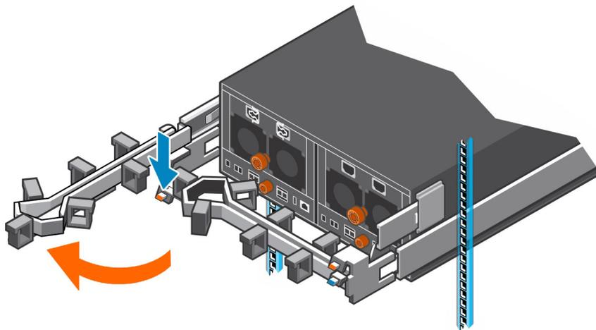
**Abbildung 67. Oberen Arm vom Gehäuse wegziehen**
