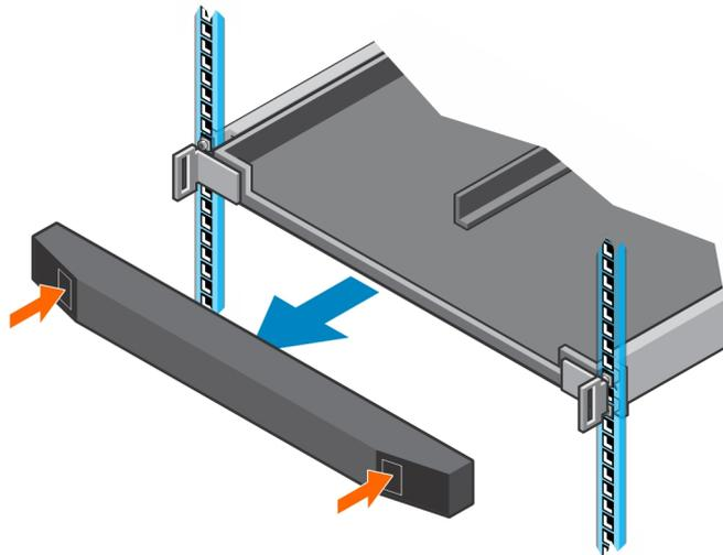
Abbildung 49. Frontverkleidung entfernen
