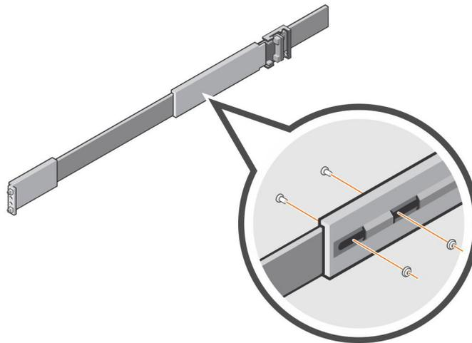
**Abbildung 16. Entfernen der Schrauben und Muttern**
