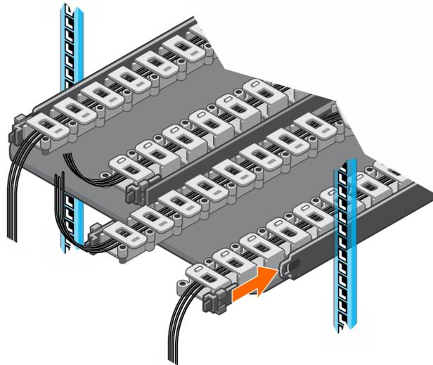
**Abbildung 12. Befestigen der Kabelketten an den Schienen**
