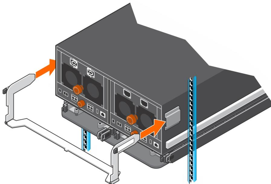
**Abbildung 13. Installieren der Gehäusehalterung am Gehäuse**
