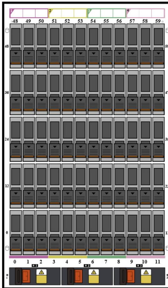
Abbildung 4. SCv360-Laufwerksnummerierung
