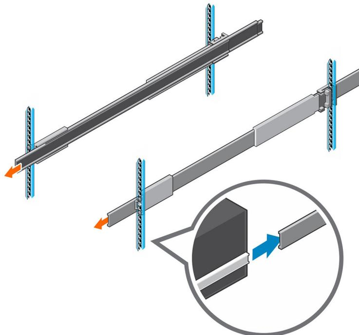
**Abbildung 19. Ausfahren der Schienen aus dem Rack**
