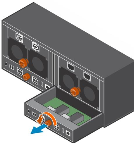
Abbildung 43. Entfernen eines EMM
