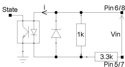
Le GPI n°3 utilise les bornes 5 & 6, le GPI n°4 utilise les bornes 7 & 8
