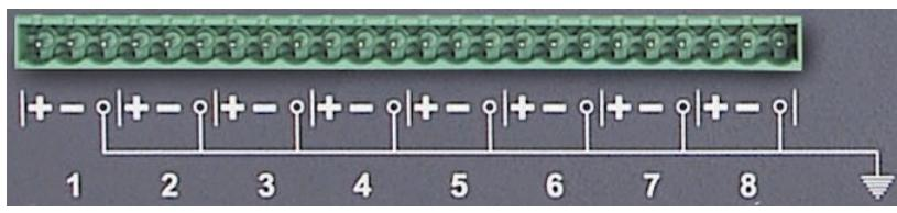
Ces entrées/sorties symétriques peuvent être utilisées avec des sources et destinations audio asymétriques. Il suffit de raccorder le point froid et la masse de l'ES8 à la masse du signal asymétrique, et de relier le point chaud au signal.
