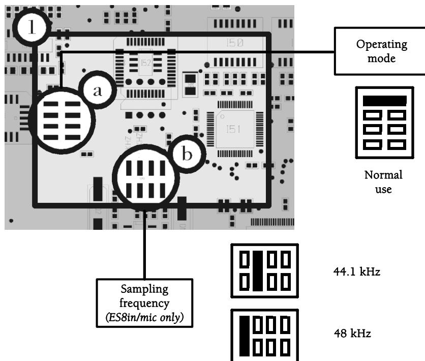
Le secteur **a** montre la position par défaut pour le mode normal de fonctionnement; ce réglage NE DOIT PAS être modifié. Cette zone de cavaliers est réservée aux opérations de maintenance.
