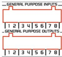
ES8in/ES8mic et ES8out possèdent quatre GPIOs optocouplés et quatre relais GPOs. Les GPIOs permettent d'envoyer des commandes au logiciel de configuration EtherSound, les GPOs peuvent être utilisés par le logiciel de configuration EtherSound pour la télécommande de dispositifs externes.
