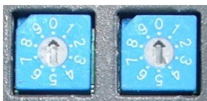
Ces deux roues codeuses décimales de la face arrière déterminent si l'attribution des canaux EtherSound aux entrées ou aux sorties d'ES8 est faite localement ou à distance par logiciel de configuration. La roue codeuse de gauche permet d'indiquer la dizaine du canal EtherSound à sélectionner. La roue codeuse de droite indique l'unité. Les canaux 1 à 64 sont réservés pour la configuration manuelle, 0 et les canaux de 65 à 99 règlent l'appareil en mode configuration à distance.
