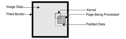
Figure 4-14 The ilPadSrc Edge Mode
