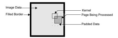
Figure 4-14 The ilPadSrc Edge Mode
