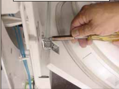
Removing door hinges
