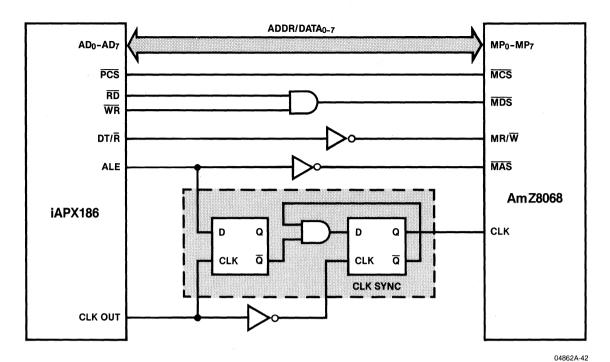
Figure 4.10. iAPX186-DCP Interface (Minimum Mode)
