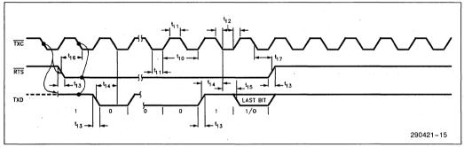
Figure 16. Transmit Timing (Intel)
