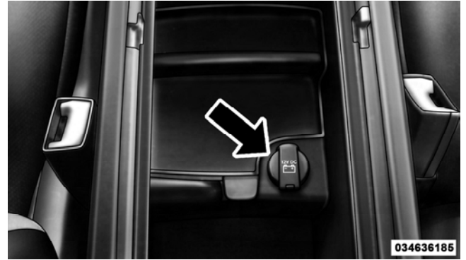
Center Console 12 Volt Power Outlet
