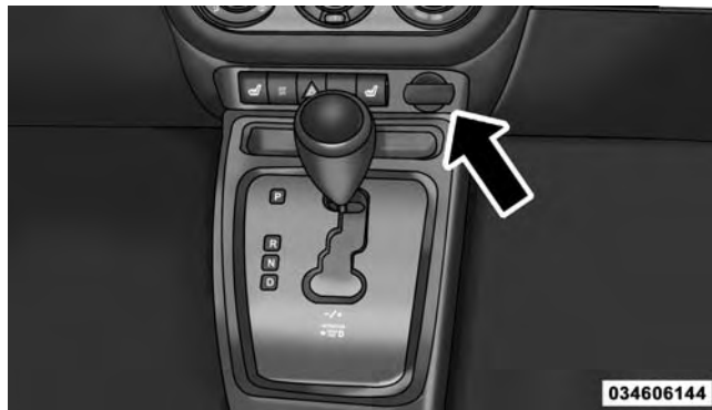
12 Volt Power Outlet
