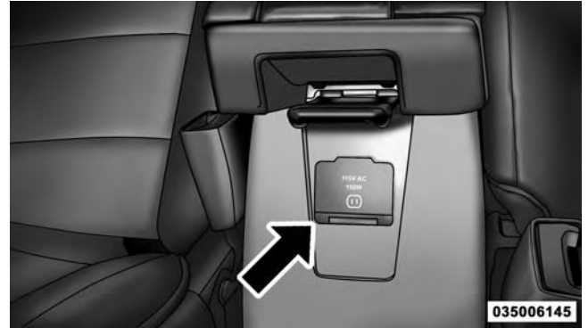
115 Volt Power Outlet
