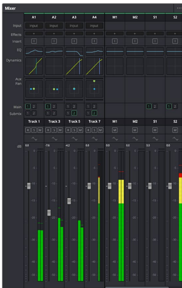
Аудиомикшер с каналами, которые соответствуют трекам на монтажной линейке
