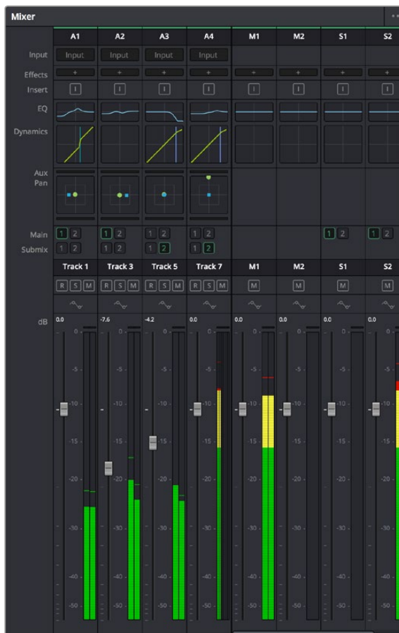
オーディオミキサー。タイムラインのトラックごとにチャンネルストリップがあります。
