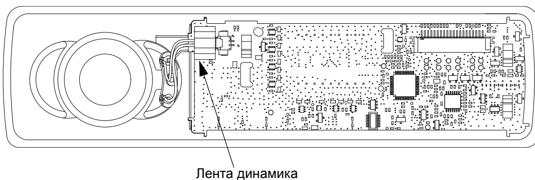
Рис. 5-36 Установка ленты динамика на печатную плату
