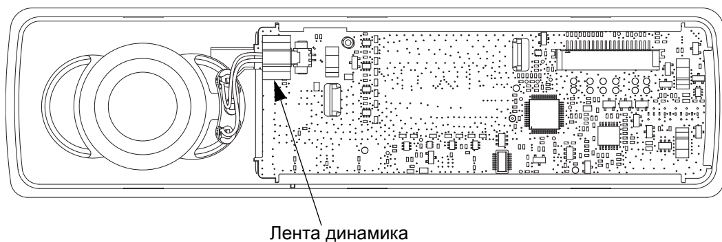
Рис. 5-29 Установка ленты динамика на печатную плату
