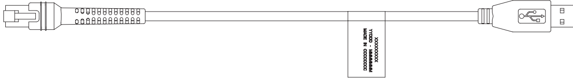
Şekil 2-1 Ön Telco MMP USB Programlama Kablosu PMKN4147_
