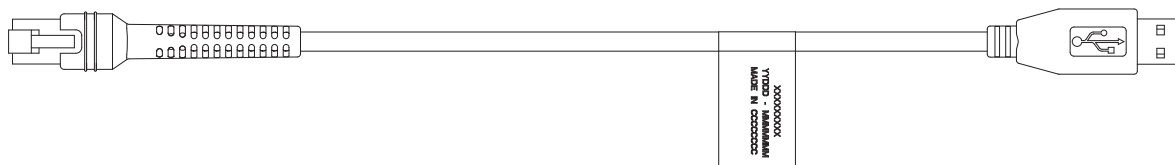
Рис. 2-1 Внешний кабель для программирования Telco с разъемами MMP и USB PMKN4147_
