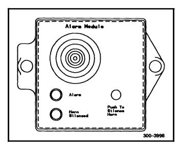
FIGURE 6-7. ALARM MODULE
