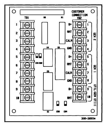
FIGURE 2-9. STANDBY SET START SEQUENCER OPTION
