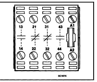
FIGURE 7-5. AUXILIARY RELAYS
