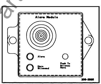
FIGURE 7-7. ALARM MODULE
