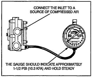
FIGURE S-8. TESTING THE DEMAND REGULATOR (LIQUID-WITHDRAWAL SYSTEM)
