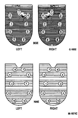
FIGURE 9-2. CYLINDER HEAD TIGHTENING SEQUENCE
