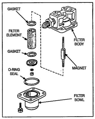
FIGURE S-9. LPG FUEL FILTER (LIQUID WITHDRAWAL SYSTEM)
