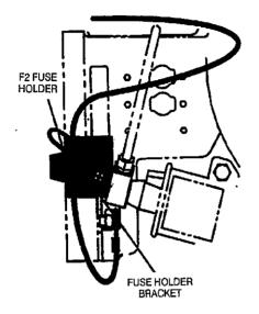
FIGURE 7-1a. AUTOCHOKE/FUEL PUMP FUSE F2 LOCATION
