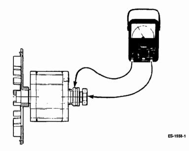
FIGURE 8-14. TESTING ROTOR FOR GROUNDS
