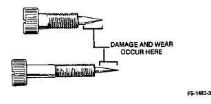
FIGURE 6-20. MIXTURE NEEDLE INSPECTION
