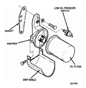
FIGURE 9-1. OIL FILTER & ADAPTER
