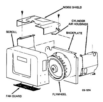
FIGURE 6-4. COOLING SYSTEM
