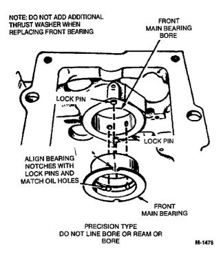
FIGURE 9-33. FRONT BEARING
