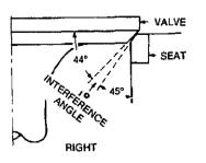
FIGURE 9-7. VALVE INTERFERENCE ANGLE
