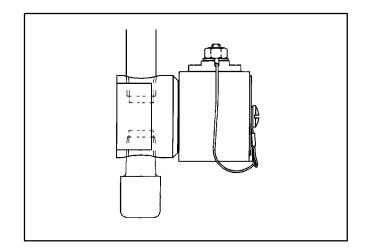
FIGURE 8-26. FUEL-SHUTOFF SOLENOID VALVE
