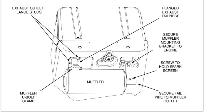
FIGURE 8-3. MODEL KVD MUFFLER
