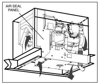
FIGURE 8-9. MODEL KVC COOLING AIRFLOW
