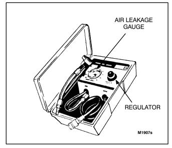
FIGURE 10-1. TYPICAL LEAK DOWN TESTER
