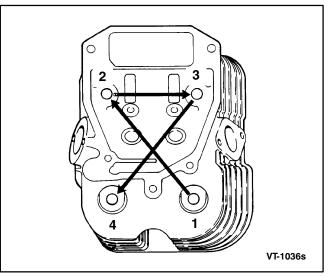
FIGURE 10-4. CYLINDER HEAD TIGHTENING SEQUENCE
