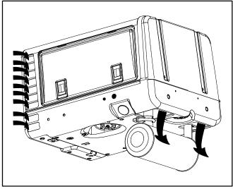
FIGURE 8-10. MODEL KVD COOLING AIRFLOW
