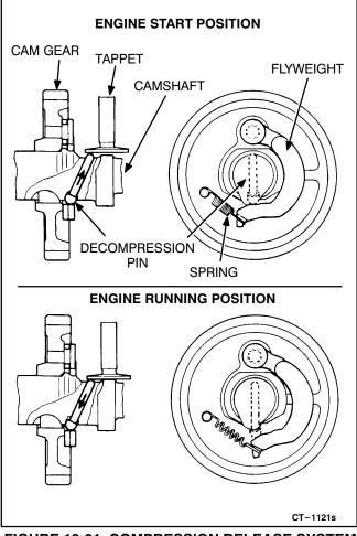
FIGURE 10-31. COMPRESSION RELEASE SYSTEM
