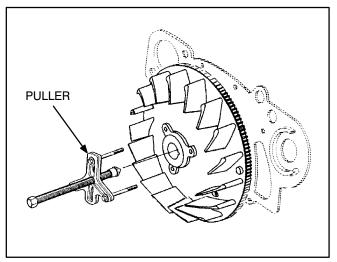
FIGURE 9-7. PULLING THE FAN HUB ASSEMBLY
