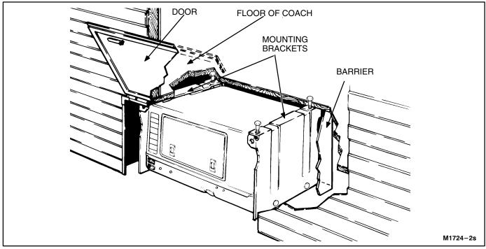
FIGURE 5-2. TYPICAL MODEL KV AND KVD UNDER-FLOOR INSTALLATION
