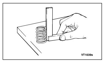
FIGURE 10-8. VALVE SPRING CHECKS
