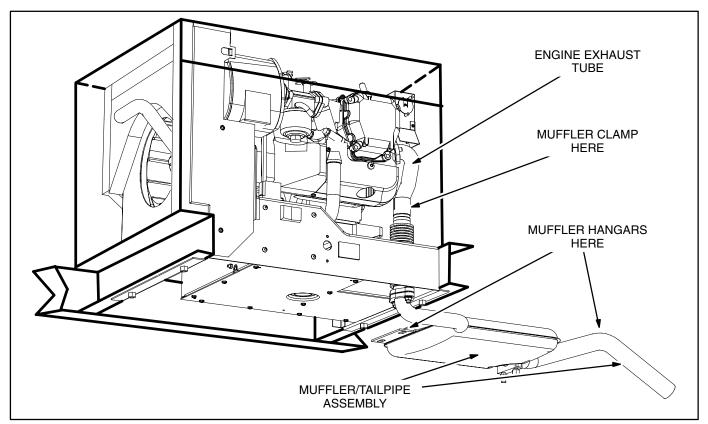
FIGURE 8-1. MODEL KVC EXHAUST SYSTEM
