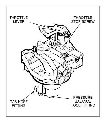
FIGURE 8-27. LPG CARBURETOR (BEGIN SPEC E, MODEL KV)
