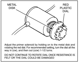
FIGURE 8-25. AUTOMATIC PRIMING SOLENOID
