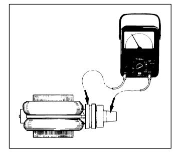
FIGURE 9-4. GROUNDED ROTOR TEST
