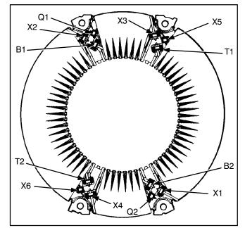
**FIGURE 9-6. STATOR ASSEMBLY**
