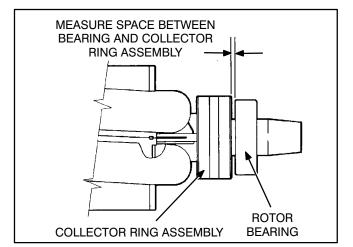
FIGURE 9-11. ROTOR BEARING SPACING
