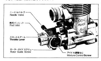
③ 次にアイドル調整ねじで、アイドリングの混合気を調整します。ローターをアイドリング位置にし、約5秒間アイドリングで運転後スロットルを全開にしてみます。この時、排気口から白煙を多く出しながらにごった音で回転がもたついて上昇するようでしたら混合気は濃すぎです。(もし、判断しにくい場合は、アイドリングの運転時間を10秒位行った後、全開にします。)
