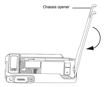
Figure 8-6. Disengage the Chassis
